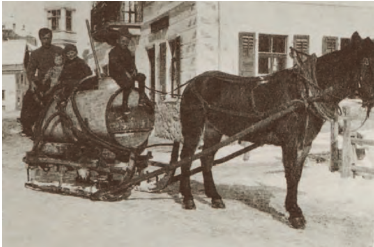
Mitten durchs Dorf: Mit dem selbst entwickelten «Fass-Schlitten» vereist Luigi die Kurven der Bobbahn.
